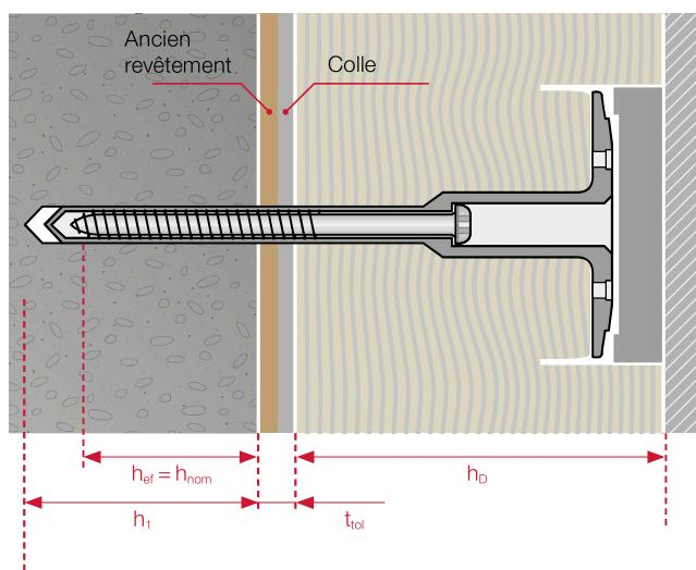
$h_1$  = Profondeur de perçage
