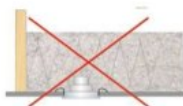
Spot non protégé au contact de l'isolant interdit
